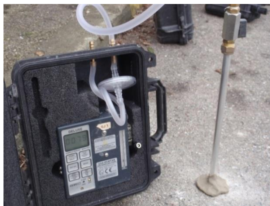
Figur 6. Poreluftsmåling i vejareal. Foto: Hanne Ingversen.
