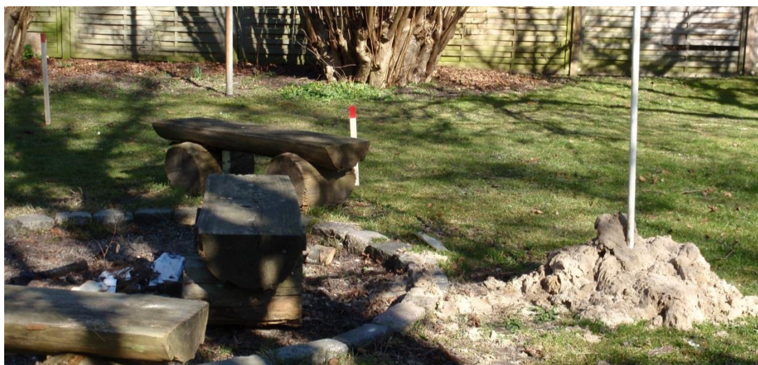
Figur 11. En geoteknisk boring (B6) er udført til højre i billedet. Her ses også et hvidt filter til vandprøvetagning. Foto Hanne Ingversen.
